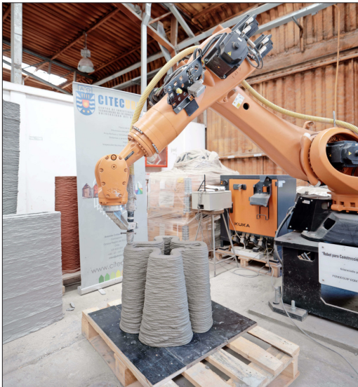
Actualmente, se están llevando a cabo las pruebas de prototipos con impresoras 3D en el Laboratorio Citec de la Universidad del Bío-Bío, que facilita sus instalaciones y su brazo robótico para los trabajos iniciales, en asociación con la Universidad Federico Santa María (USM).
